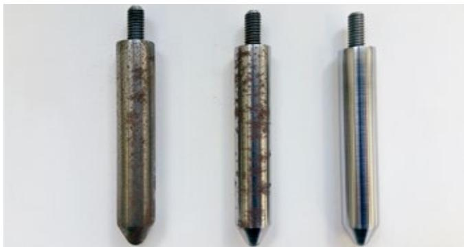
Фото 1. Баббитовые стержни промывались маслом 24 ч при 60 °С: стержень, промытый маслом ADDINOL Turbine Oil CA (справа), без следов коррозии. Стержни, промытые обычными турбинными маслами (слева и в центре).
