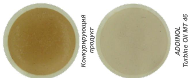
Фото 1. Колориметрическое определение по методу LTAT
