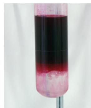
Фото 3. Водоотделительная способность по DIN 51589/1 (для наглядности турбинные масла были подкрашены)
