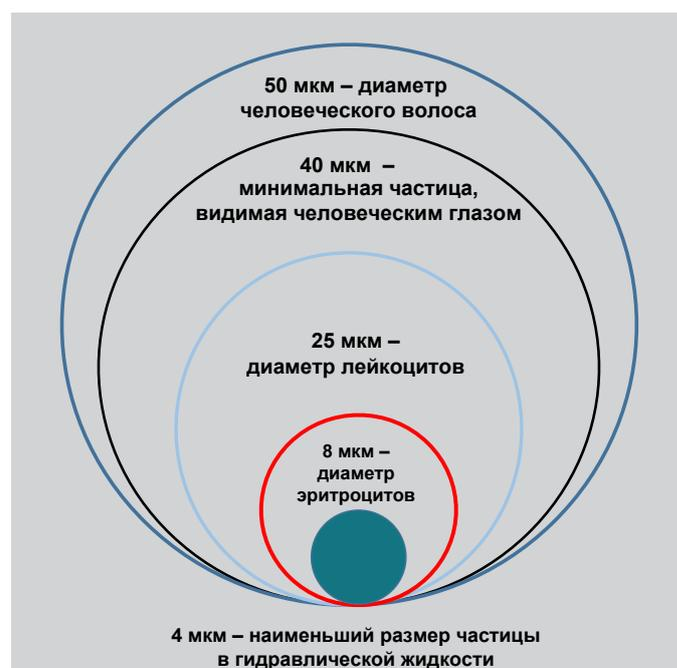
Илл. 1. Гидравлические системы надежно работают в присутствии частиц микрометрового диапазона (размером от 1 до 5 мкм). Примесные частицы порядка 15 мкм являются для современных систем уже крупными. Для лучшего понимания: человеческий глаз различает частицы размером не менее 35–40 мкм. Таким образом, любое видимое загрязнение уже означает серьезную опасность для оборудования и отдельных узлов системы.
