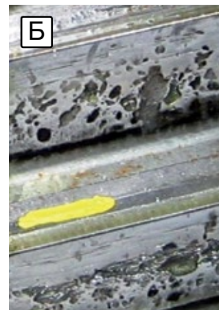
Фото Б: Значительное сглаживание через 5 месяцев после перехода на Eco Gear 460 M
