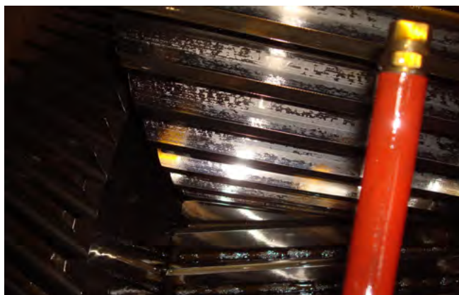
väikeratas, mida pole määratud Eco Gear 320 S õliga: äratuntav mikropiting hammaste külgpindadel
