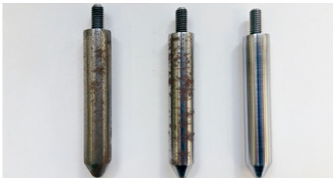
Joonis 1: babiitvardad, uhetud 24 h 60 °C temperatuuril: ADDINOL Turbine Oil CA (paremal) õliga uhetud vardal pole erinevalt tavaliste turbiiniõlidega uhetud varrastest (vasakul ja keskel) näha korrosioonijälgi
