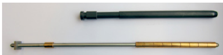
Joonis 3: pidevpresside varraste kaks põhiliki: SIEMPELKAMP (rullvardad üleval) ja DIEFFENBACHER (paindevardad all)
