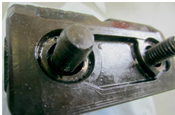
Sadestisteta keti detail pärast ca 18 500 tunnist tööd ADDINOL Cliptec XHS 280-ga
