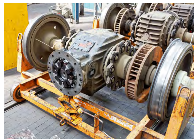
Kompaktsed rattapaari reduktoore peavad toime tulema kriitiliste töötingimustega, mis tulenevad pideva kiirendamise ja pidurdamise vaheldumisest.
