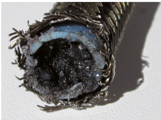
Konkurendi toode – sadestistega ummistunud õlitoru Конкурирующий продукт — маслоподающая трубка закупорена отложениями
