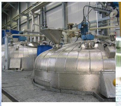
Tähtsaim element mootoriõlide tootmisel: segamisreaktor Leuna tehases.
