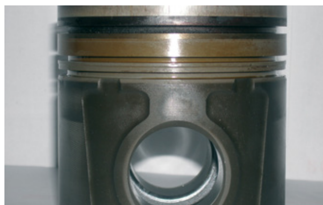
kolb ja rõngasooned – MWM TCG 2016 V12
