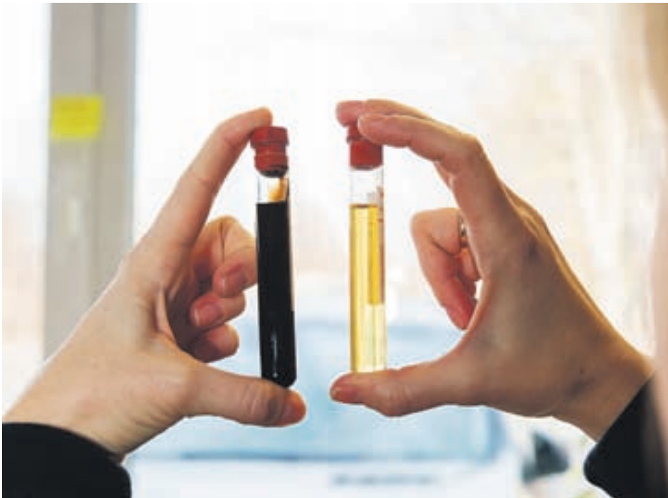
KUI kuldkollane värske mootoriõli muutub kiiresti tumedaks, on tegemist heade pesemisomadustega õliga. FOTO: MEELI KÜTTIM
