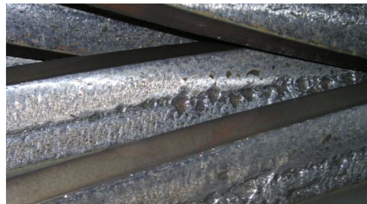
Kahjustatud pindade (jaotusringjoonele tekkinud kulumisjälgede, ebatasasuste, hõõrdumisest tingitud vao) silumine on lõppenud, see on nähtav ja tuntav. Enam ei eksisteeri teravaid ääri ja servi. Fotod: Addinol
