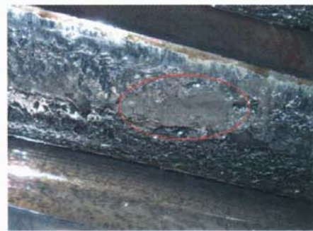
Joonis 1. Õli Eco Gear tekitatud plastilise deformatsiooni tulemusel tasandunud laik reduktori hambal
