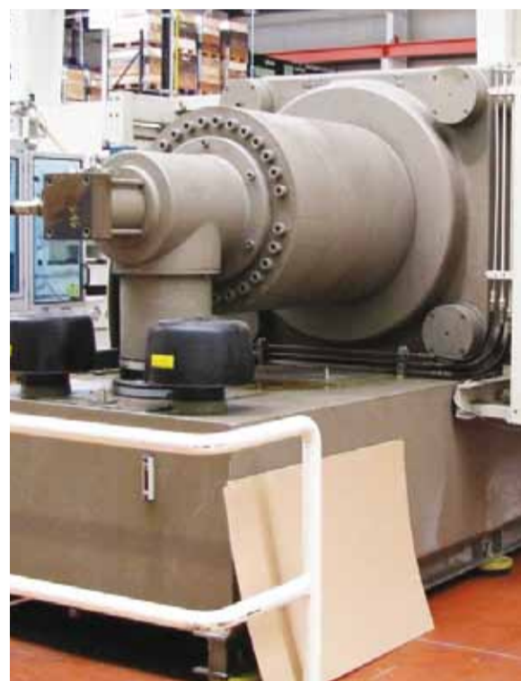
Alates 2009. a veebruarist töötab see 6500 kN masin ühes autotööstust varustavas ettevõttes Addinoli HV Eco Fluidiga ja kulutab tänu sellele peaaegu 5% vähem energiat. Hüdroüsteemi õlimahut on ca 1500 l.
