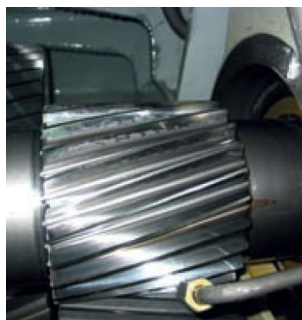
Микропиттинг в ветрогенераторе
