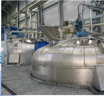
Центральный элемент производства моторных масел: установка по смешению на заводе в Лойна.
