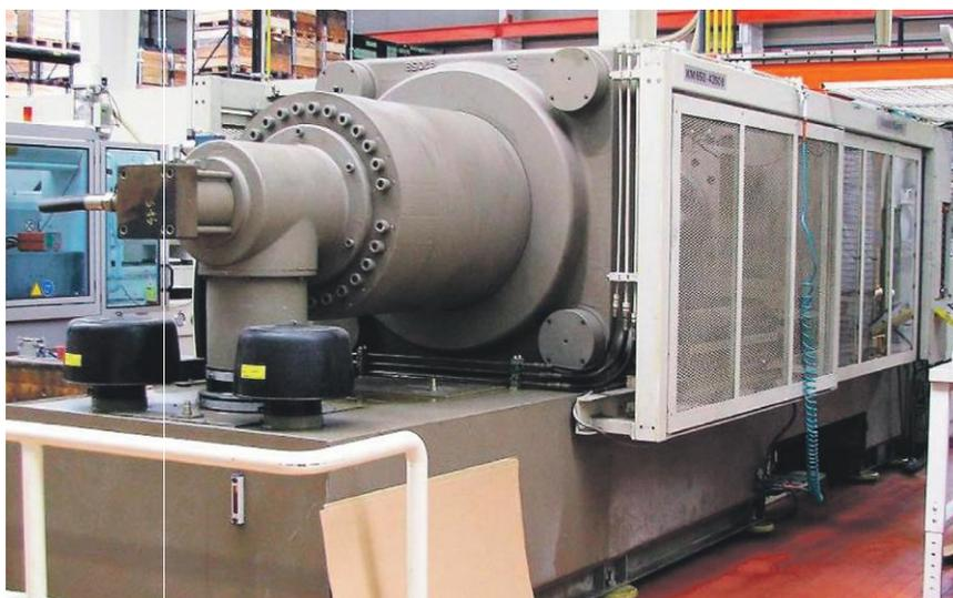
*Используемый в автомобильном строительстве термопластавтомат с гидроприводом от фирмы Krauss-Maffei, прижимное усилие которого 65 кН.*
