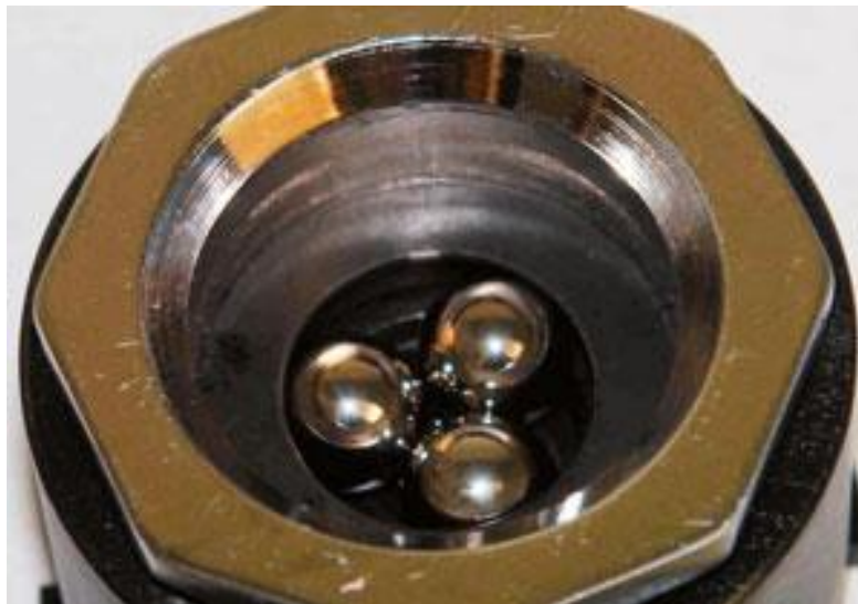
ДЕРЖАТЕЛЬ В ФОРМЕ ЧАШИ с неподвижными шариками, залитыми смазочным маслом. Фото: ADDINOL LUBE OIL OÜ
