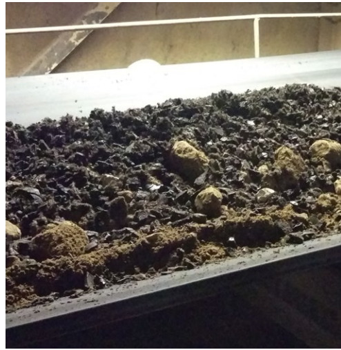
Põlevkivile lisatud rehvhakke transport konveieriga.
