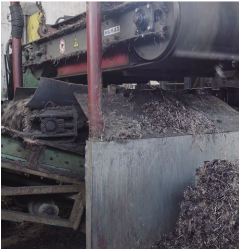
Metalli- ja tekstiiliosakeste eraldamine hakitud rehvimaterjalist.
