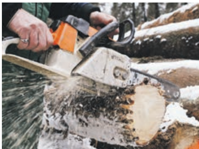
▲ Saeketi eluiga väheneb vale õlitamise tõttu. FOTO: INDREK SUSI
