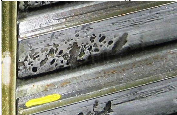
Olukord 5 kuud pärast ADDINOL Eco Geari kasutuselevõttu: vanade kahjustuste terved servad on juba ümarad.
