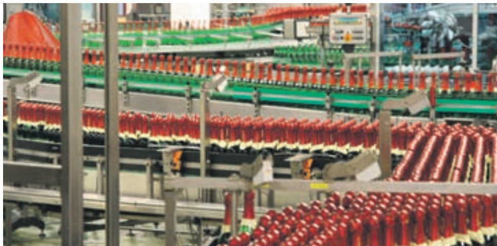
SAKSAMAA vahuveinitootja Rotkäppchen kasutab oma liinide õlitamisel NSF H1 sertifikaati omavaid Addinoli määrdeaineid. FOTO: ADDINOL
