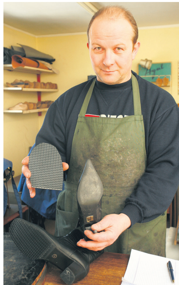
Kingsepp Ivar Avik näitab, kuidas saab siledatallalise saapa muuta libedakindlaks.
