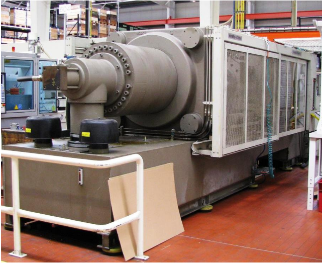
Alates 2009. a veebruarist töötab see 650 kN masin ühes autotööstust varustavas ettevõttes Addinol HV Eco Fluidiga ja kulutab tänu sellele peaaegu 5% vähem energiat. Hüdroüsteemi õlimaht on ca 1500 l.
